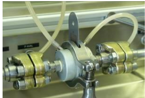
Figura 6 : Dispositivo experimental da IFTS que está de acordo com o padrão ISO 16332
